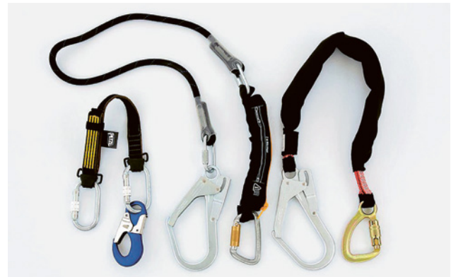
10 Aufreißband, als Falldämpfer in ein Halteseil eingebaut. Bei einer Belastung von etwa 3 kN (300kg) beginnt das Band aufzureissen.
