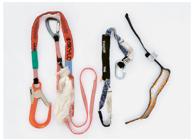
11 Beispiele aufgerissener Falldämpfer. Das Aufreissen dämpft den Fallstoss.
